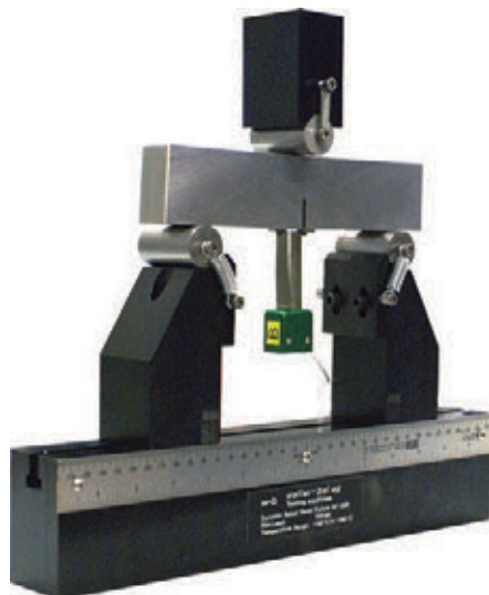
Устройство для испытаний образцов в виде балок (SEB) по схеме трехточечного изгиба
